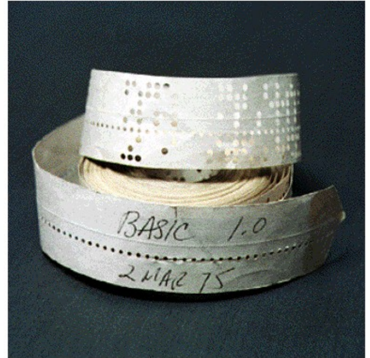
Il nastro perforato contenente la versione 1.0 dell'interprete Microsoft BASIC
