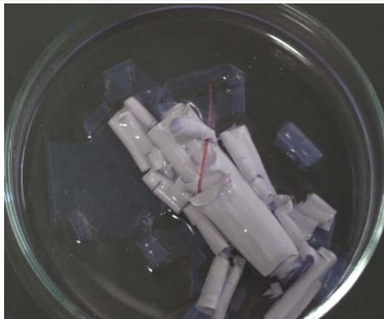
Abbildung 5.1. Mifare-Classic-Karte nach 30 Minuten in Aceton
