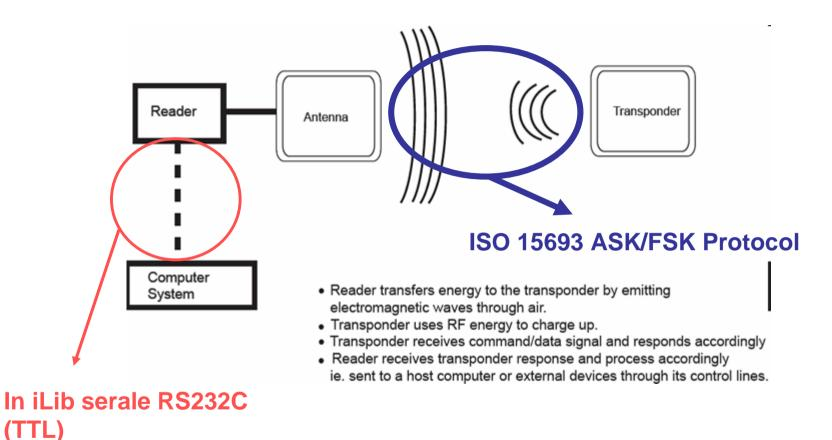
Schema a blocchi di un sistema ad RFID
